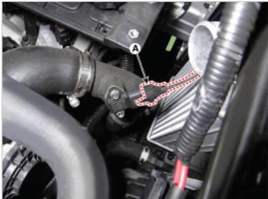
11. 分离中冷器排气软管&导管(A)。
