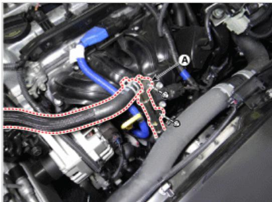
14. 分离真空软管(A)、节气门体冷却水软管(B)和电控节气门(ETC)总成连接器(C)。
